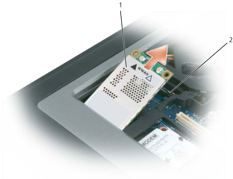
1 モバイルブロードバンドカード 2 金属製固定タブ (2)
